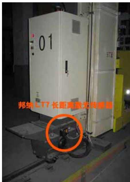
安装于堆垛机上的 LT7 激光测距传感器
