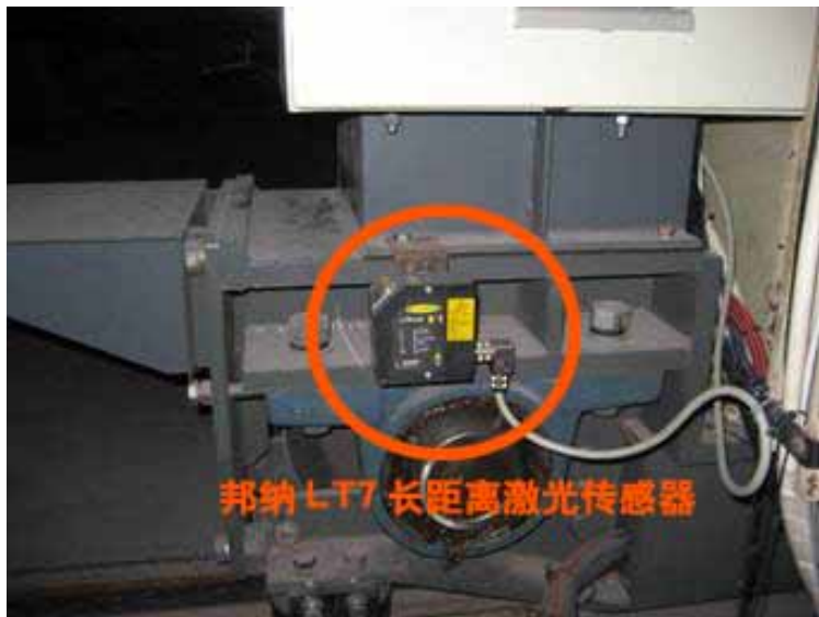
安装于堆垛机上的 LT7 激光测距传感器
