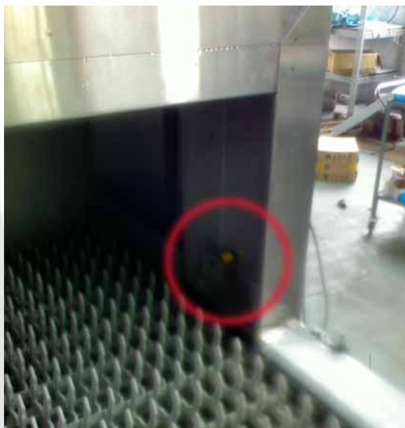
安装在洗碗机上的 S18 光电传感器（内侧）
