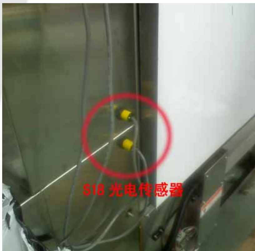
安装在洗碗机上的 S18 光电传感器（外侧）
